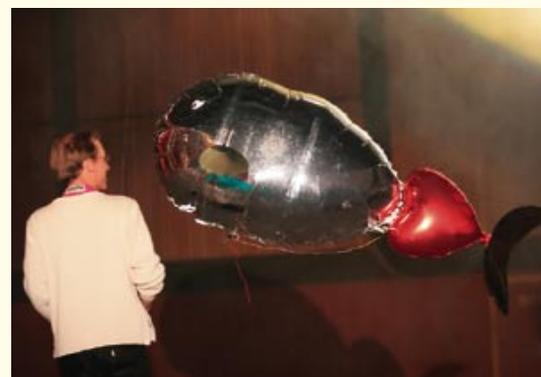
**Die heliumgefüllte Wanda bewegt sich ohne Propeller, einzig durch Flossenbewegungen, durch die Luft. Diese Konstruktion von Martin Müller ist bereits sechs Jahre alt**
